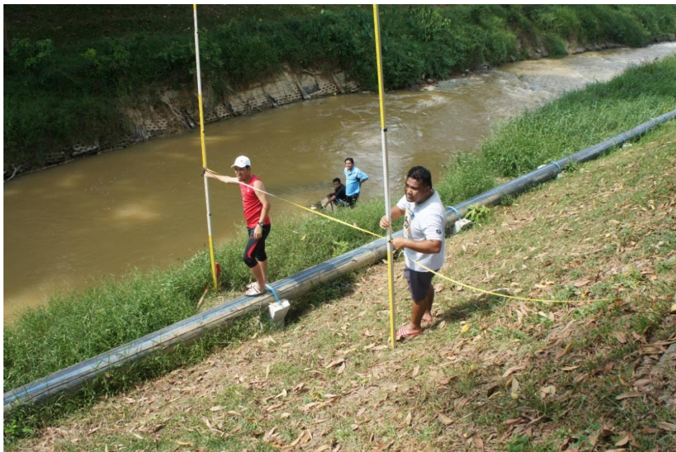
Kerja ukur dibuat bermula dari tebing sungai untuk mendapatkan profil sungai yang tepat
