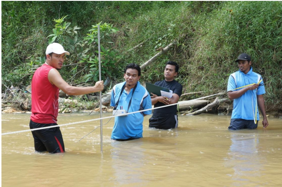
Kerja sukat luah dijalankan menggunakan kaedah Flow Meter
